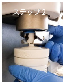
図 4. MP-AES 耐フッ酸トーチへの耐フッ酸スプレーチャンバの取り付け。
