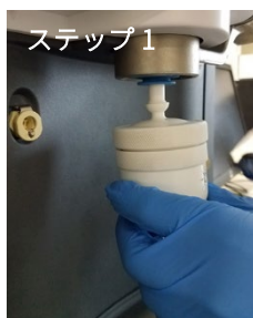
図 4. MP-AES 耐フッ酸トーチへの耐フッ酸スプレーチャンバの取り付け。
